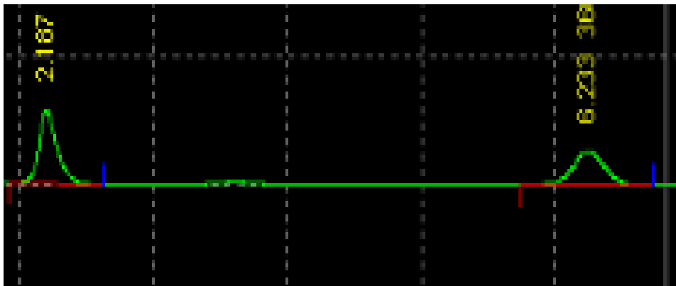
الشكل (60): يوضح مخطط فصل مزيج فيتاميني A و E بطريقة HPLC (80%)
